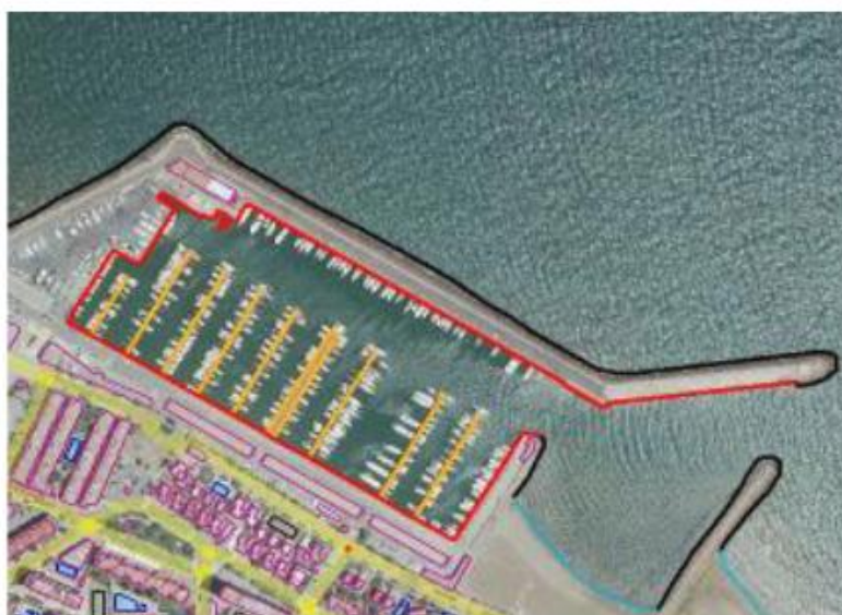
Ejemplo de otras construcciones atributo TIPO = Muelle (color rojo), pantalán (naranja) y escollera (negro)
